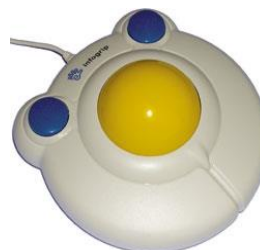
Obr. 12 – Trackball ( nahrazuje pohyb myši po stole pouhým otočením kuličky na jednom místě )
